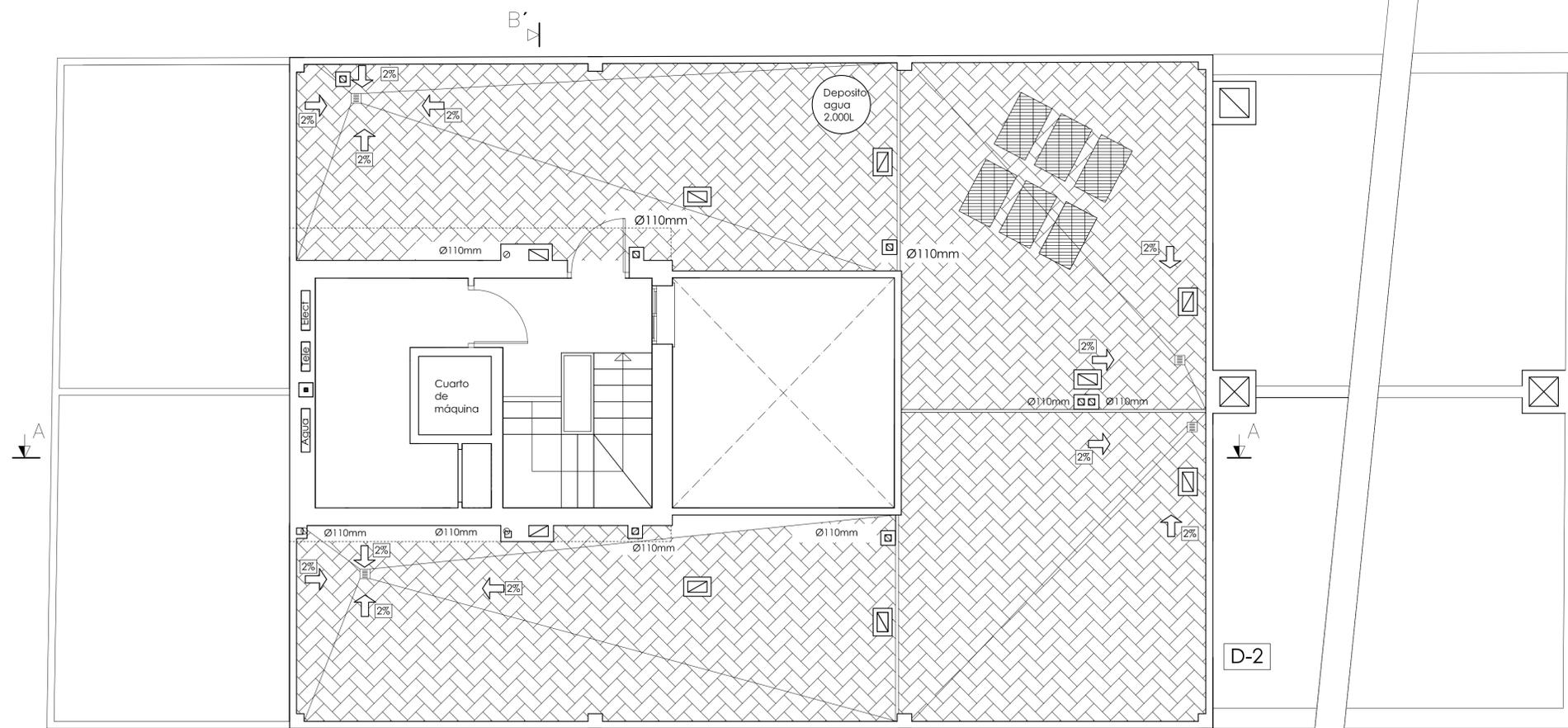
Cubierta transitable, con faldón de hormigón aligerado y pavimento de rasilla con mortero asfáltico
